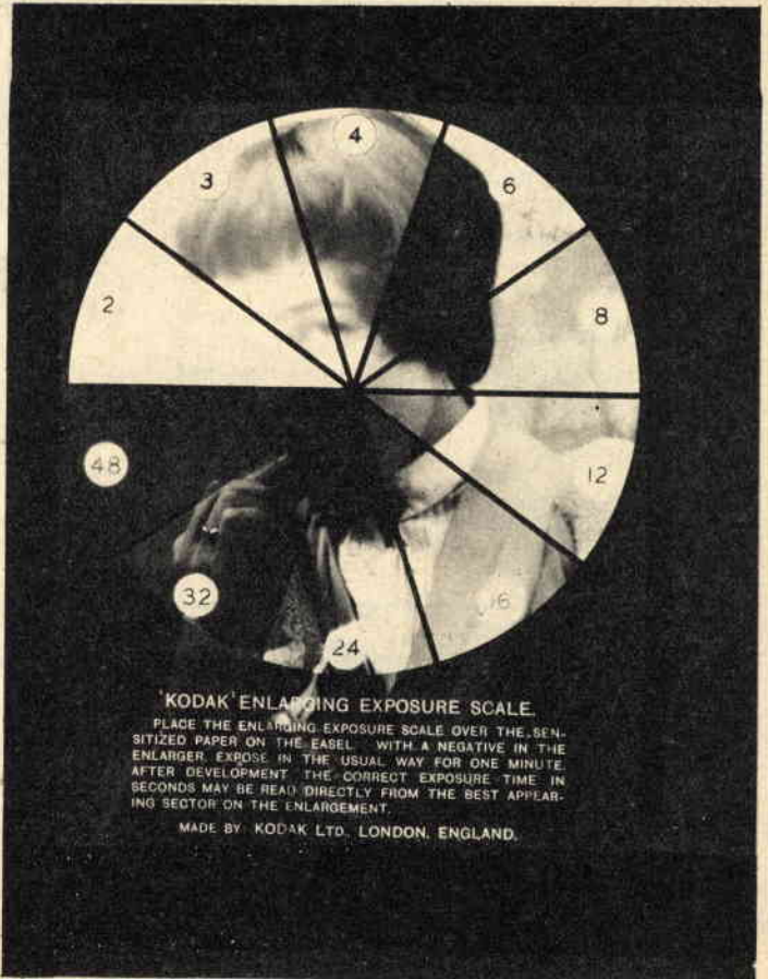
Fig. 10 - La Kodak mette a disposizione dei fotografi uno speciale schermo di esposizione. Tale schermo viene appoggiato ad un foglio di carta sensibile; si espone il tutto per 60 secondi; si sviluppa normalmente per 2 minuti primi. Sull'immagine risultante sceglieremo il settore che ci dà il positivo normale. Il numero che appare entro cerchietto in ogni settore ci indica il tempo di posa in secondi.
